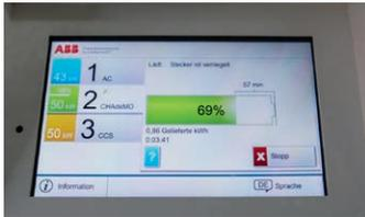
5 Der Ladevorgang wird gestartet und am Display werden Sie über Ladezustand der Batterie, Restladedauer, gelieferte kWh und bereits abgelaufene Ladezeit informiert.
