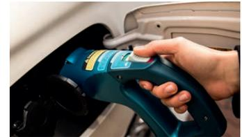
3 Ziehen Sie den Stecker ab und platzieren Sie diesen wieder in der Halterung. Bei CHAdeMO (siehe Bild): durch Betätigen des Schiebers nach vorne den Stecker lösen. Geben Sie den Parkplatz nach dem Laden für andere frei.
