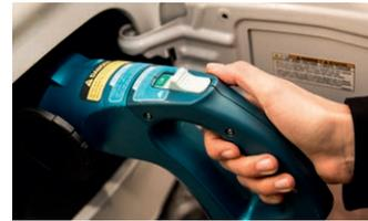
3 Stecken Sie den Stecker in die Ladebuchse des Fahrzeuges bis er einrastet.
